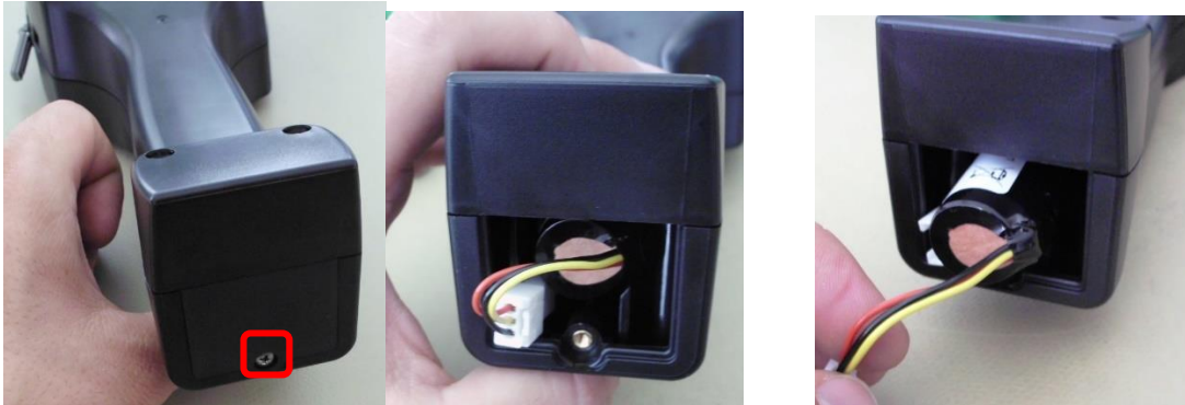
Het batterijdeksel verwijderen
