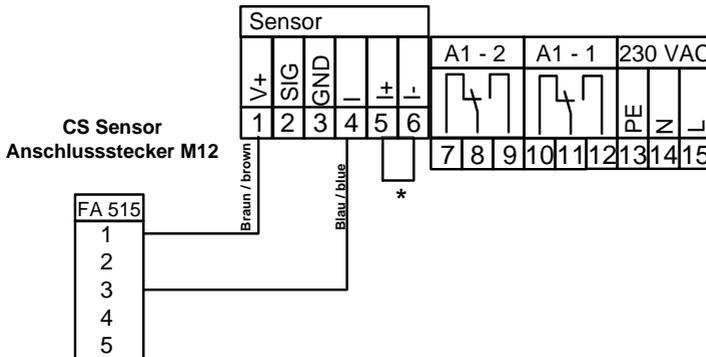
\* Ab Werk ist eine Brücke eingebaut. Zur Signalweiterleitung bitte Brücke entfernen und Anschlussleitungen anbringen. Achtung: Stromschleife muss geschlossen sein!
