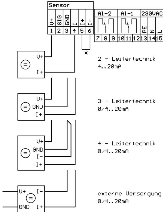
\* Ab Werk ist eine Brücke eingebaut. Zur Signalweiterleitung bitte Brücke entfernen und Anschlussleitungen anbringen. Achtung: Stromschleife muss geschlossen sein!
